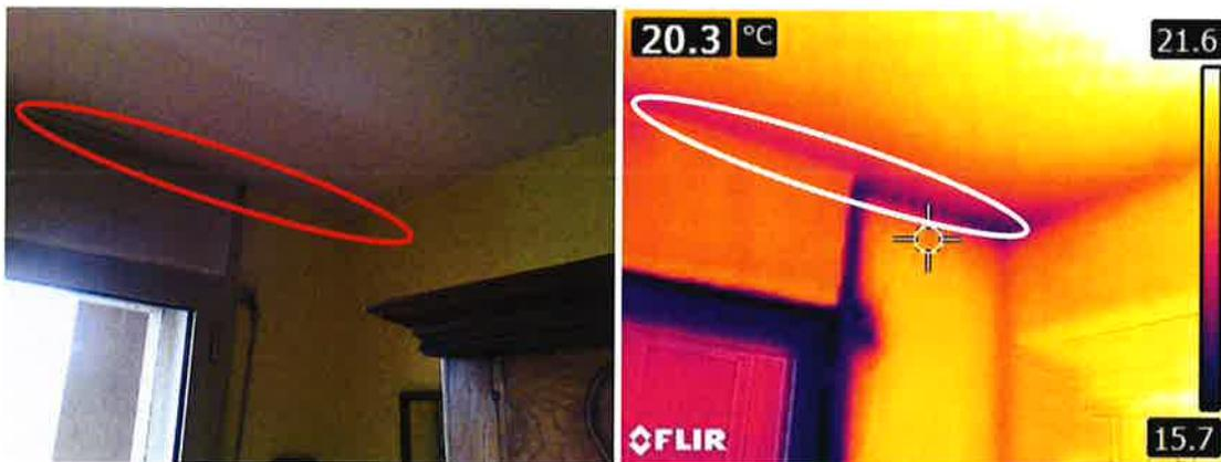
**Intérieur d'un logement sur rue /** Le phénomène des ponts thermiques vue de l'intérieur des logements. Contrairement à une vue thermique extérieure, depuis l'intérieur, les ponts thermiques sont de couleur plus sombre (traduisant des pertes de chaleur plus importantes).
