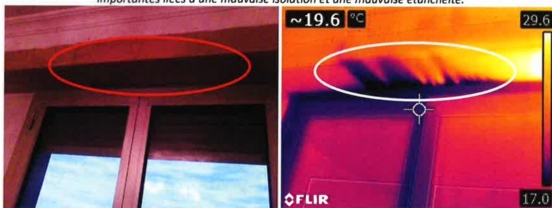
Intérieur d'un logement - Coffre de volets roulants / Les zones sombres traduisent les infiltrations d'air liées à une mauvaise étanchéité à l'air sur un caisson de volets roulant.
