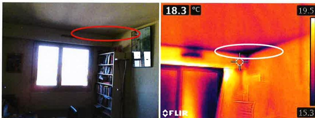
Intérieur d'un logement - Coffre de volets roulants / Les zones sombres traduisent les déperditions thermiques importantes liées à une mauvaise isolation et une mauvaise étanchéité.
